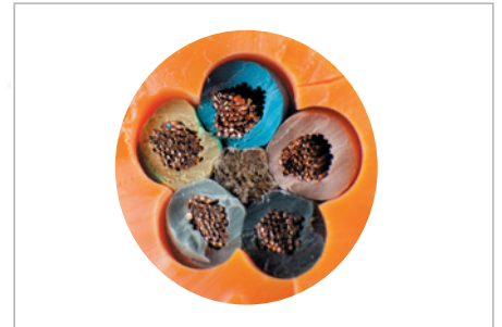
unterschiedliche Wanddicke des Außenmantels different thickness of outer sheath
